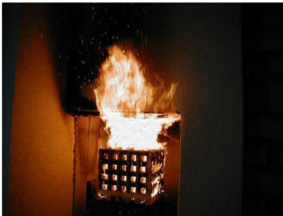
Imagen: Ensayo de fuego en fachada
