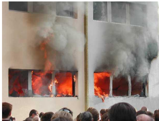
Imagen: Ensayo de fuego en fachada con EPS (después de 27 minutos)
