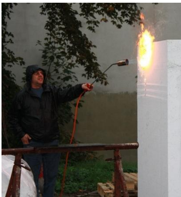
Imagen del bloque para construcción de EPS cuando se le aplicó la llama
