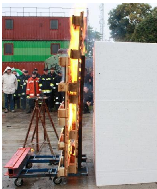
Imagen de la quema del pallet de madera enfrente del bloque para construcción de EPS
