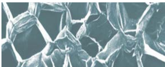
Imagen: Estructura de celdas del EPS en el microscopio
